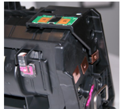
Chip: Über den kann der Drucker überprüfen, ob es sich um original HP-Toner handelt.
